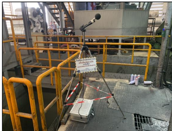
รูปที่ 3.11 การตรวจวัดระดับเสียงในพื้นที่ทำงาน ( L_{eq} 8 hr.) บริเวณ Cold Mill Area
