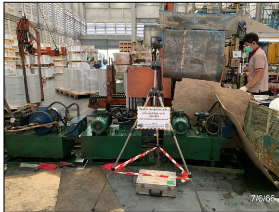
รูปที่ 3.13 การตรวจวัดระดับเสียงในพื้นที่ทำงาน ( L_{eq} 8 hr.) บริเวณ Flash Annealing Area No. 2
